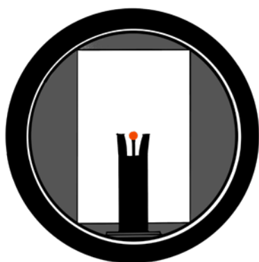
Прицеливание. Вы сводите красную точку оптического прицела с открытым прицелом.
